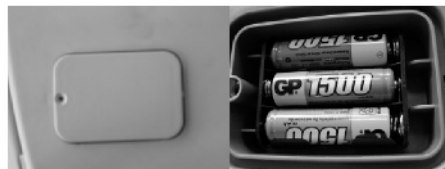
Figura 9 – Locaș baterii din titan+ - Model vertical
